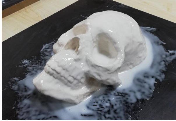
Resim 4. İlk Silikon Kat Uygulamasının Ardından Modelin Görünüşü.
