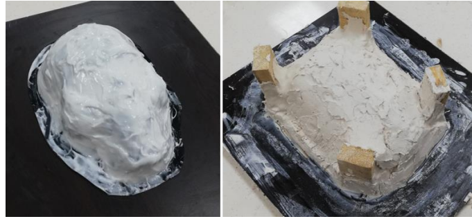
Resim 6. Üçüncü Silikon Kat ve Alçı Kabuk Uygulaması.
